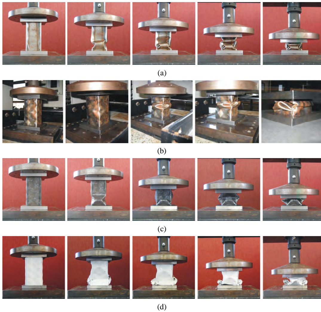
Fig. 3.9 Crushing processes of (a) C2, (b) P1, (c) P4, and (d) M2.
